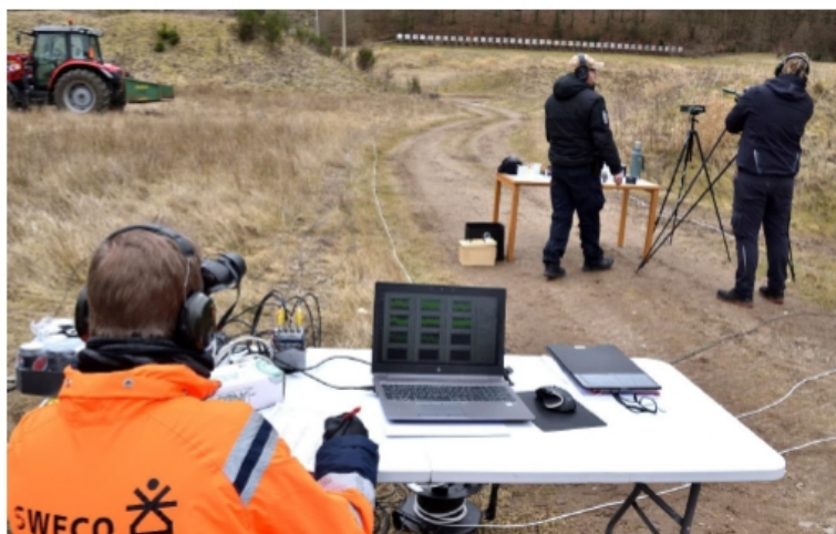
Billede 4: Måleopstilling til Riffelskydning. Skydning blev foretaget fra 50 meters afstand – den kortest mulige afstand hvor alle testens projektiltyper må anvendes til skydning på stålmål. På alle skud blev placering af træf på målet registreret til evt. senere analyse. Foto: Bo Madsen, Sweco Acoustica
