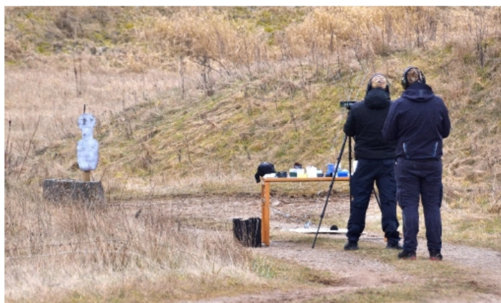
Billede 3: Måleopstilling til pistolskydning. Rundt stålmål og Torso mål. Skydning blev foretaget fra 10 meters afstand. På alle undersøgelsens skud blev der målt hastighed på projektilet, til evt. senere analyse. Foto: Bo Madsen, Sweco Acoustica
